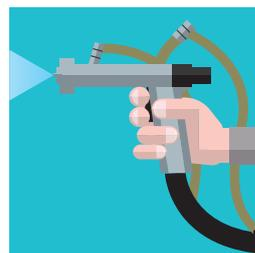
超微粒子の「酸化チタン+酸化銅」を、超低圧ガンで塗布します。
